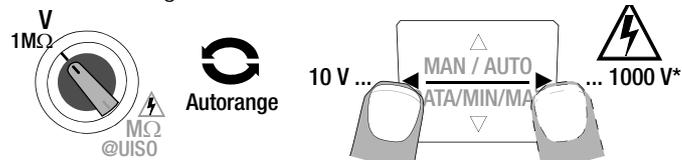
La tension d'essai sélectionnée apparaît sur l'afficheur lors de la mesure.
