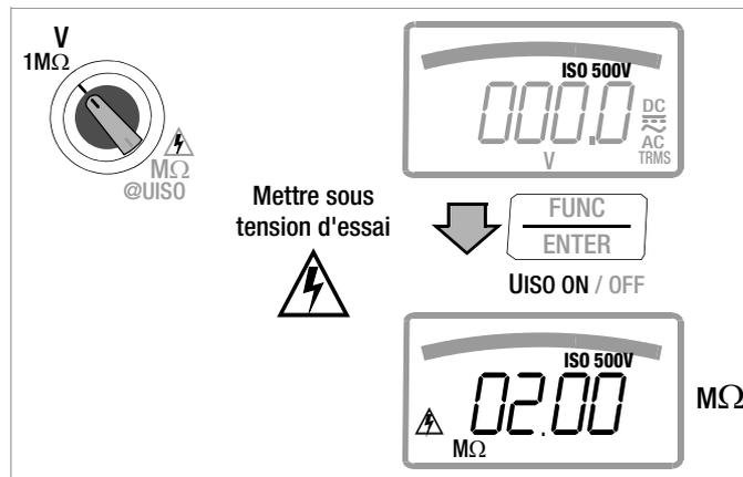
La sélection automatique de la plage de mesure est activée pendant la mesure de la résistance d'isolement.
